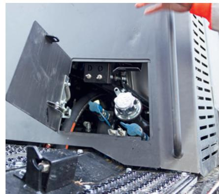
El llenado de combustible y aceite hidráulico es fácil al poder realizarlo de pie junto a la máquina.
