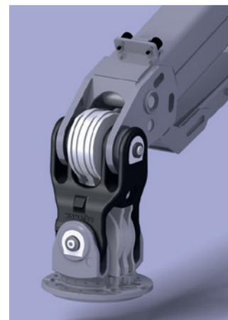
grúa y en la grúa. La base de la grúa está integrada con la placa giratoria, lo que aumenta la resistencia y reduce la necesidad de mantenimiento. Una función inteligente es el bloqueo de transporte que está integrado en la función de giro; esto facilita el transporte en un tráiler y el mantenimiento. Durante la conducción en carretera se puede bloquear el giro de la grúa con una válvula mecánica para mayor seguridad.
