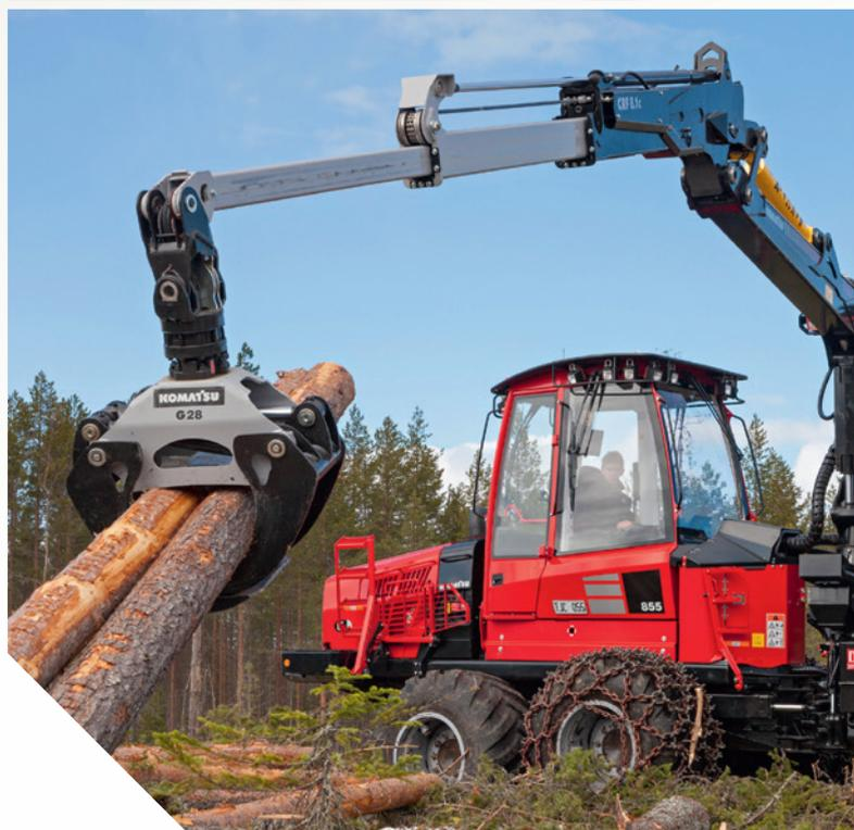
**ProTec em ação.** O sistema ProTec com roteamento de mangueiras protegido através do link é um dos vários exemplos em que a Komatsu Forest e a Indexator colaboraram no trabalho de desenvolvimento.
