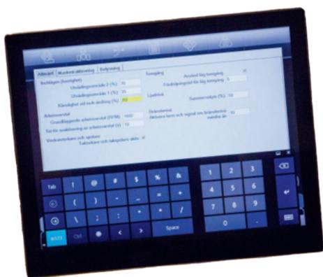
**O NOVO COMPUTADOR** é o MaxiPC X40 e foi projetado especialmente para as necessidades das máquinas florestais. Isso significa, entre outras coisas, um processador de quatro núcleos para velocidade e um disco rígido SSD para confiabilidade. E além disso, sem ventoinha.
