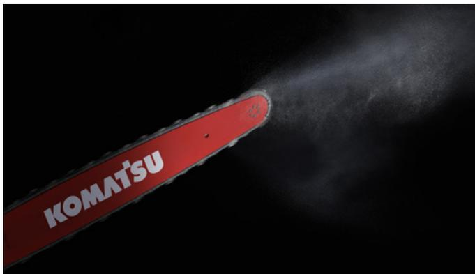
Para-brisas limpos e menos tempo de paralisação desnecessário. O sistema de lubrificação Eco-GLS elimina o problema de névoa de óleo no para-brisa já que a graxa permanece no sabre e na corrente.
