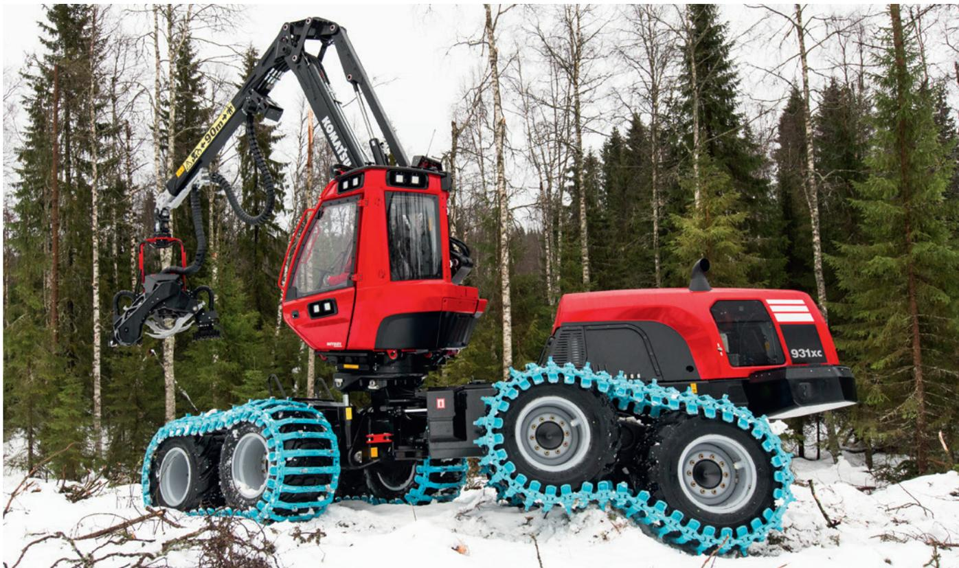
La double oscillation signifie une articulation rigide et un essieu oscillant combiné à un bogie monté sur l'essieu oscillant. Permet une remarquable accessibilité et un confort maximal dans les pentes et les sols meubles.
