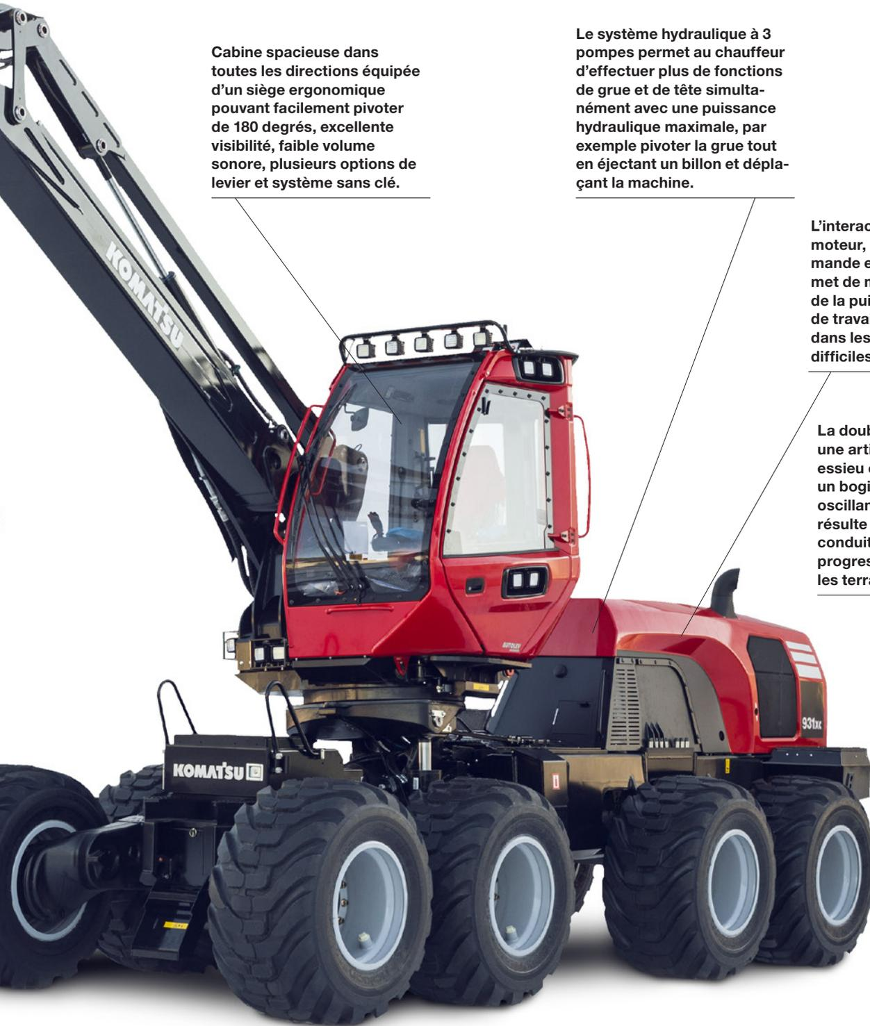
Cabine spacieuse dans toutes les directions équipée d'un siège ergonomique pouvant facilement pivoter de 180 degrés, excellente visibilité, faible volume sonore, plusieurs options de levier et système sans clé.
