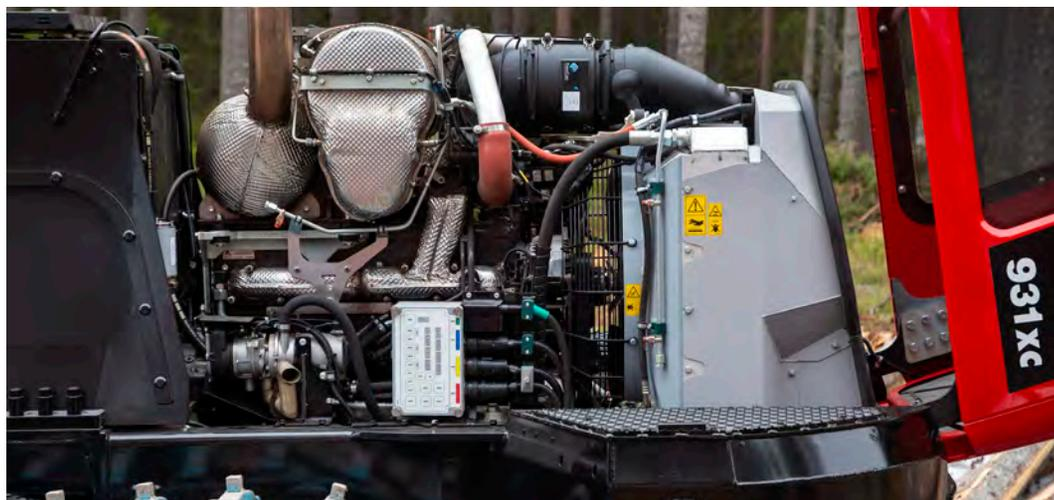
Новый двигатель, отвечающий последним требованиям законодательства по вредным выбросам. Новинка предоставляет вам целый ряд преимуществ: это и полностью обновлённая система AdBlue, и новая выхлопная система, и гидрокомпенсаторы клапанов.
